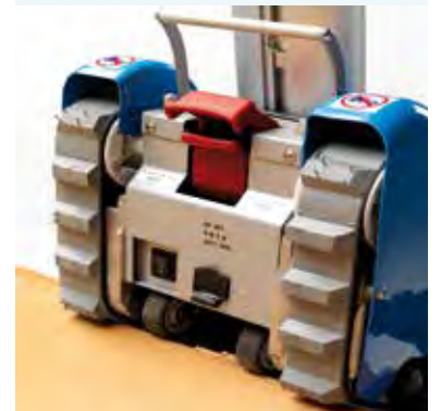
נעילה כפולה מכנית וחשמלית - של חיבור מוט ההיגוי אל תא המנוע.
